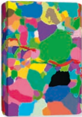
Visualisation de la progression d'une fissure dans un alliage d'aluminium.
